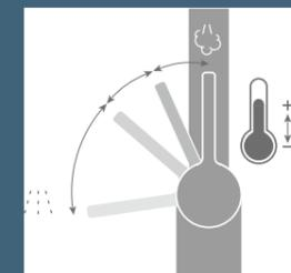
Rimuovere la leva e girare il dado all'interno per limitare la temperatura dell'acqua\*
