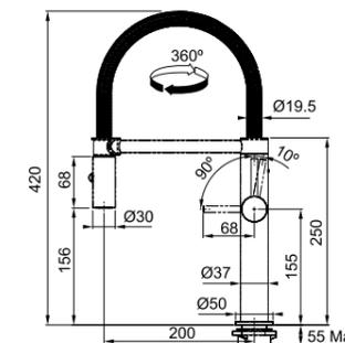
AISI 304 Questi miscelatori sono realizzati interamente in acciaio inox AISI 304.
